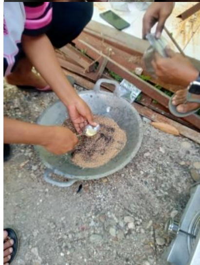
Gambar 8 : campurkan kedua bahan serbuk asam dan arang cangkang kemiri dan gel kanji
