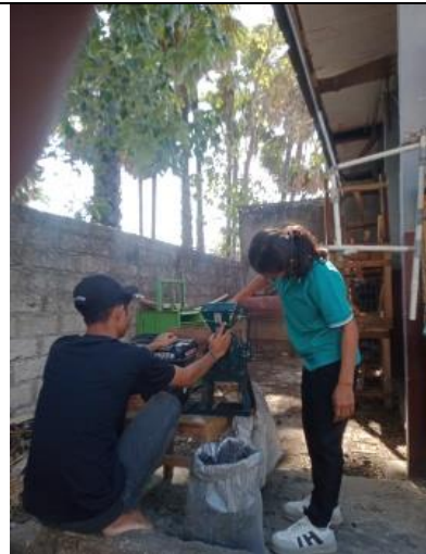
Gambar 4 : Penggilingan kedua bahan (asam dan arang cangkang kemiri )
