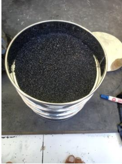
Gambar 5: Pengayakan serbuk dengan ukuran 40 mesh
