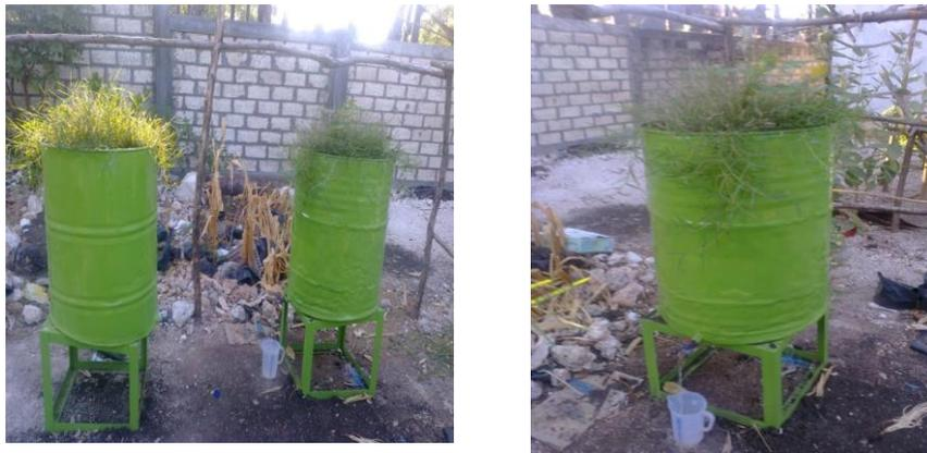
Gambar 1. Konstruksi Lysimeter Sederhana
