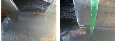
(gambar alat Cipoletti pada saluran)
